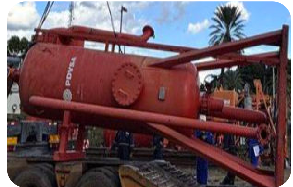
SEPARADOR DE GAS PDV-TC-SG-15
