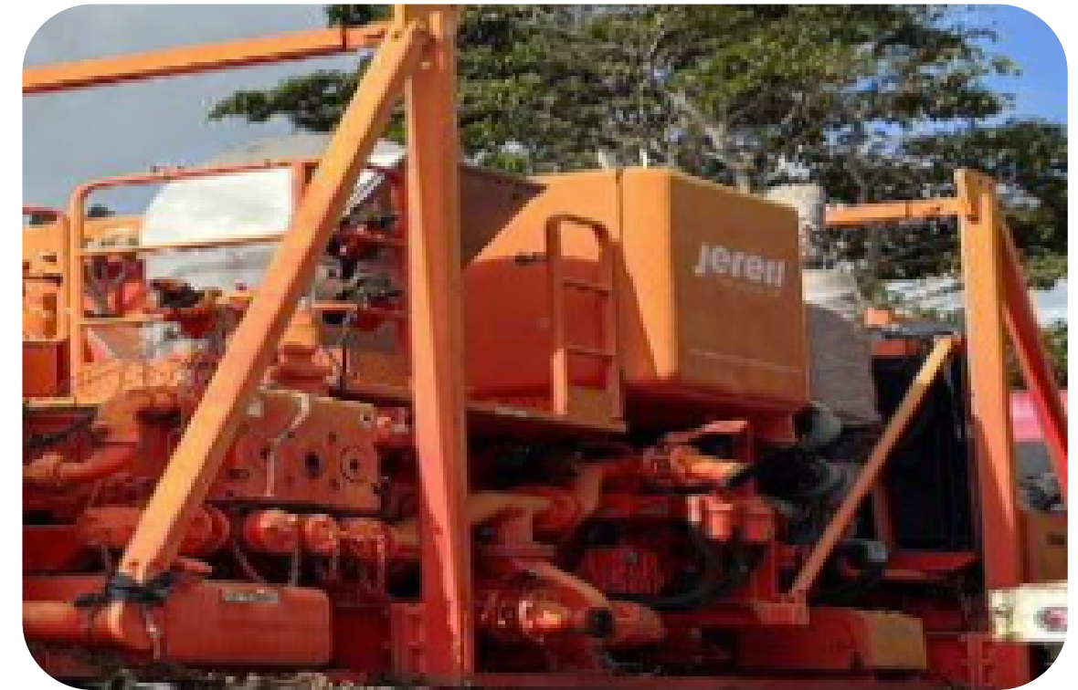
BOMBA DE ACIDIFICACION PDV-TC-BA-15
