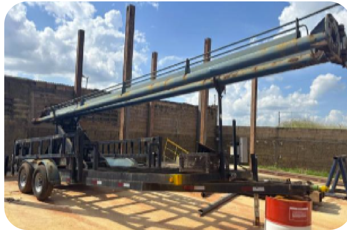
QUEMADOR DE WELL TESTING (2)
