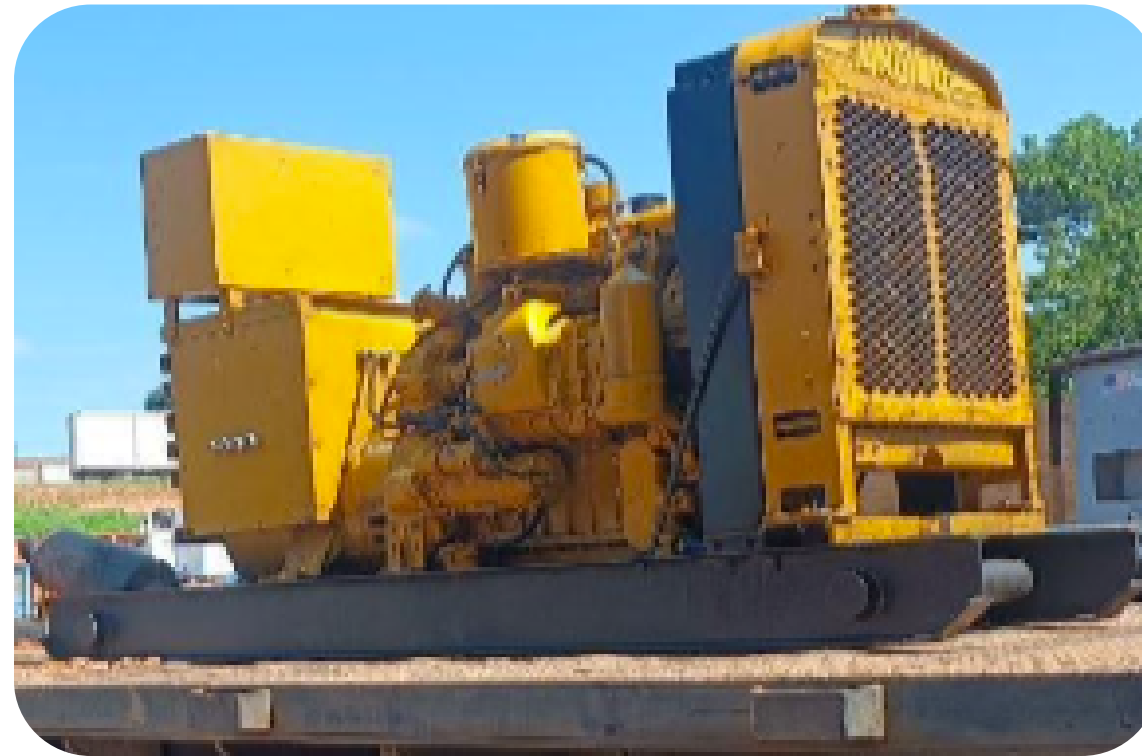
GENERADOR ELÉCTRICO DETROIT
