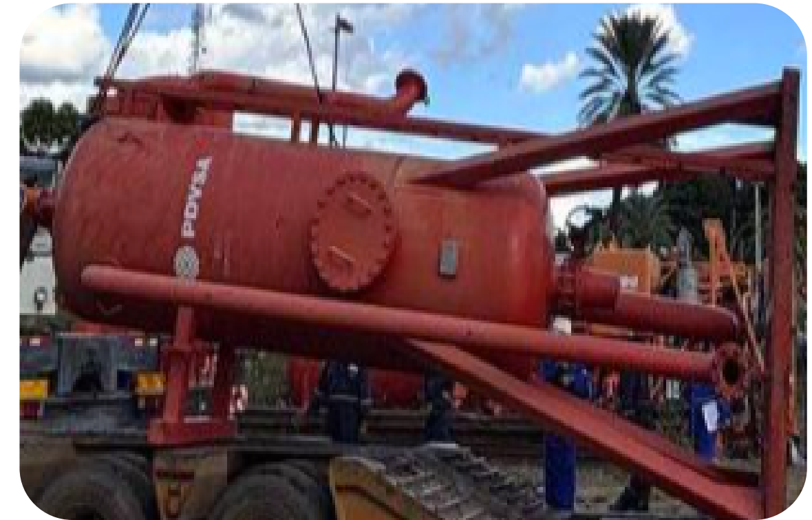
SEPARADOR DE GAS PDV-TC-SG-15
