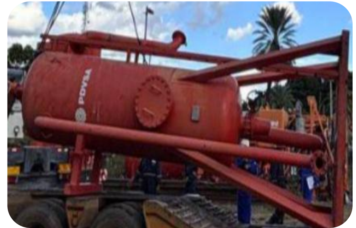
SEPARADOR DE GAS PDV-TC-SG-15
