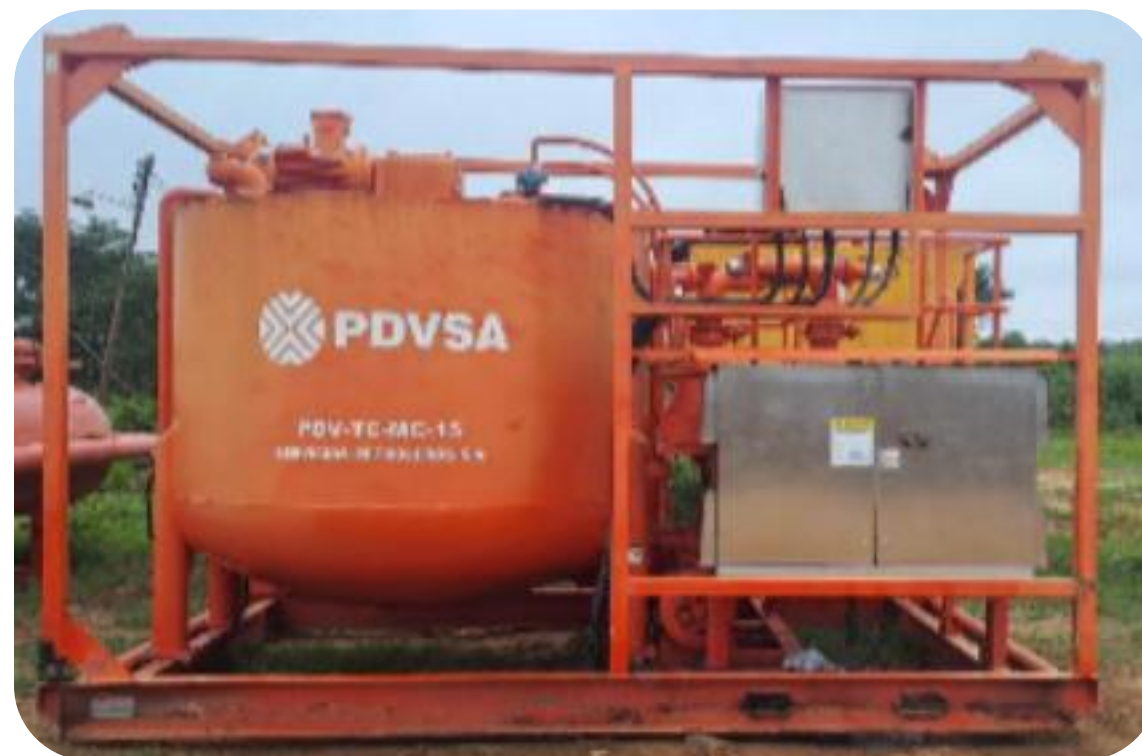
TANQUE CON MIXER PDV-TC-MC-15
