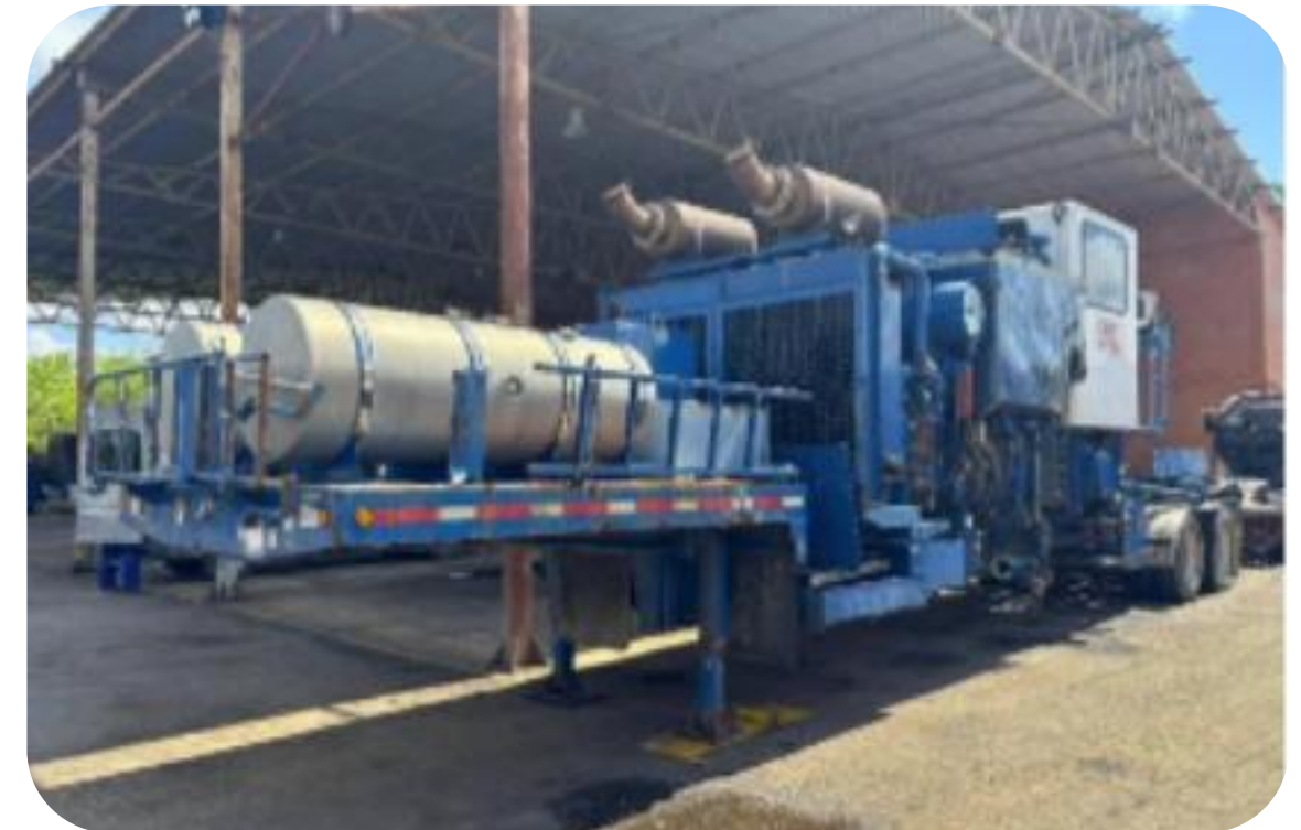
BOMBA DE ALTA T518129
