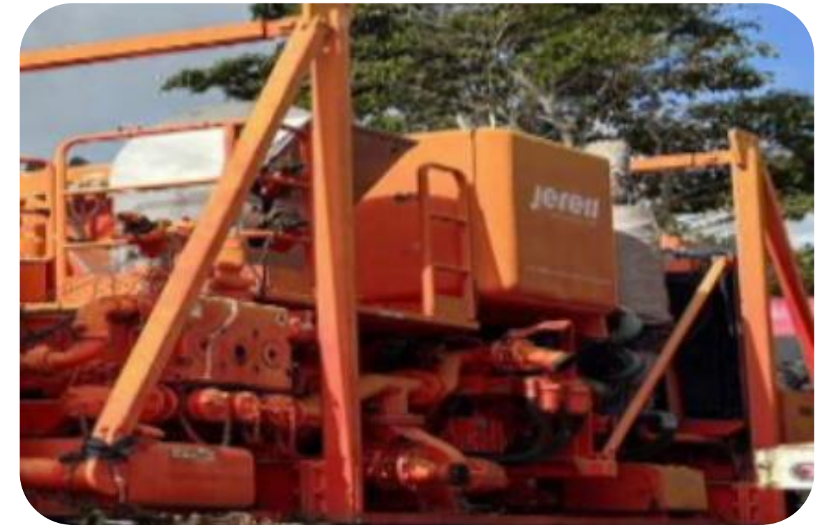
BOMBA DE ACIDIFICACION PDV-TC-BA-15
